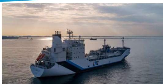
SUISEI FRONTIER, Jaapan, vedela H_2 transpordi tanker, 116 m pikk, DWT 9000 tonni, 1,250 m 3 mahuti; 2022 esimene vedu Austraaliast-Jaapanisse
