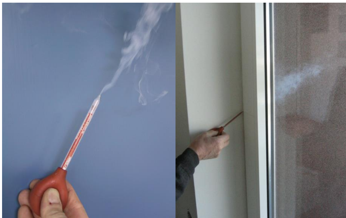
Joonis 2.6 Märkesuitsuanduri kasutamine õhulekkekohtade leidmisel
